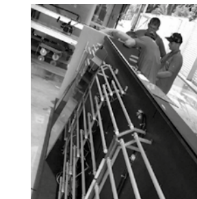
Suporte metálico para as lâmpadas
