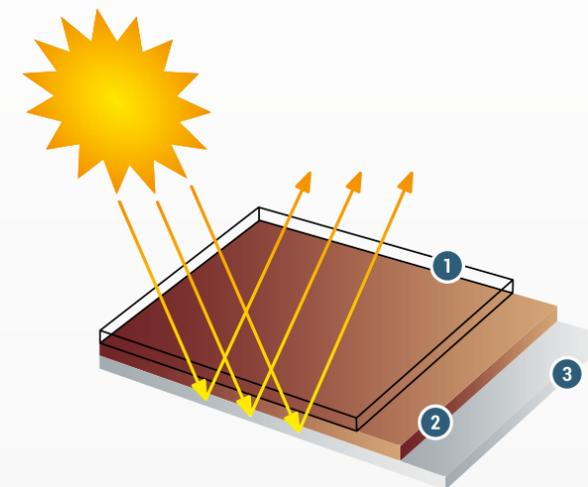
1 - Camada acrílico 60µm | 2 - Camada base | 3 - Camada refletiva branca
